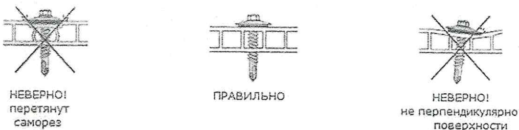
Рисунок 18 – Установка крыши на парковку
